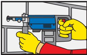
Perçage d'un trou avec une perceuse électrique au diamètre et à la profondeur requis. Le diamètre du trou de forage doit être conforme à la taille de l'ancrage.
