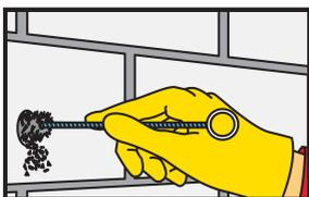
Le trou de forage doit être soigneusement nettoyé avec la brosse en acier spéciale (brosse au moins 2 x). Le diamètre de la brosse doit être supérieur au diamètre du trou de forage.
